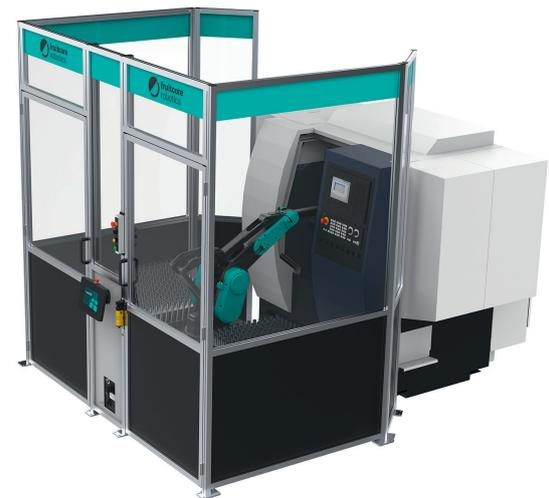
1 Das modulare Solution Kit ‘Machine Tending II’ automatisiert die Be- und Entladung von Werkzeugmaschinen mit nur minimalem Aufwand © Fruitcore
